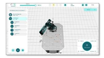
Bildunterschrift: Die Programmierung und Verkettung komplexer Pfade ist nun auch in der grafischen Bedienoberfläche von horstFX möglich.
