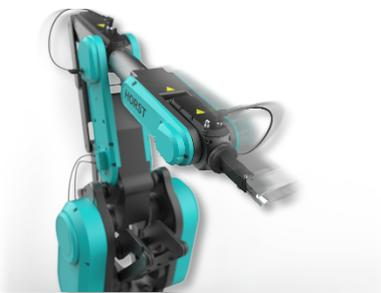
Bildunterschrift: HORST1000 G2 ist mit der Schutzart IP54 für raue Produktionsumgebungen gerüstet.
