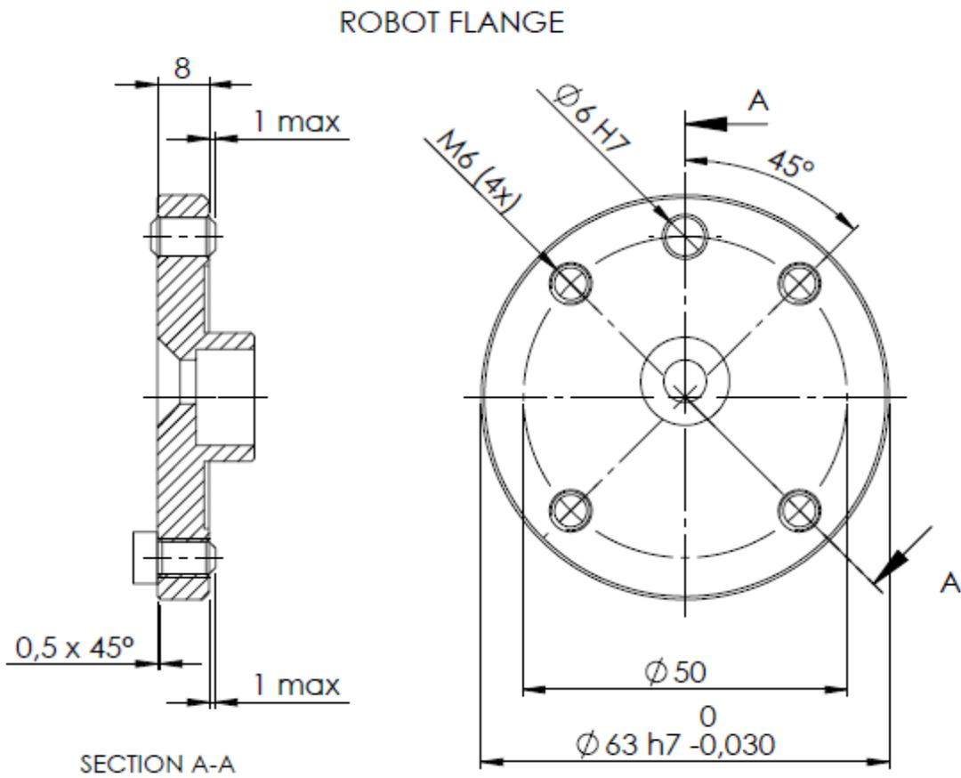
Flansch aller HORST-Robotermodelle
