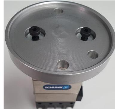
Beachte: Die Adapterplatte muss nach dem Anziehen vollständig auf dem Greifer-Gehäuse aufliegen. Die Zwischenfläche ggfs. reinigen. Weiter muss sichergestellt werden, dass die Schraubköpfe nicht aus der Fräsung herausstehen.
