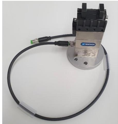
Danach wird das Übertragungskabel am Roboter angeschraubt. Hierfür wird die rechte Buchse am Tragarm 3 des Roboters verwendet. Ist die Kommunikation sichergestellt, kann der Greifer in horstFX über TOOL-OUTPUT-1 und TOOL-OUTPUT-2 angesteuert werden.
