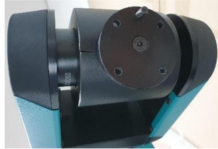
Danach wird der vormontierte Greifer mit Hilfe des Zentrierbolzens ausgerichtet und in der entsprechenden Orientierung auf den Roboterflansch gedrückt. Hierbei ist zu beachten, dass die Flächen sauber und frei von jeglichen Verunreinigungen sind. Ist dies sichergestellt kann der Greifer mittels den Zylinderschrauben DIN 6912, M6x12 am Roboter befestigt werden.
