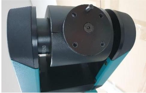
Danach wird der vormontierte Greifer mit Hilfe des Zentrierbolzens ausgerichtet und in der entsprechenden Orientierung auf den Roboterflansch gedrückt. Hierbei ist zu beachten, dass die Flächen sauber und frei von jeglichen Verunreinigungen sind. Ist dies sichergestellt kann der Greifer mittels den Zylinderschrauben DIN 6912, M6x12 am Roboter befestigt werden.
