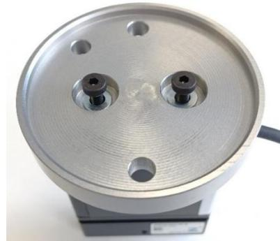
Beachte: Die Adapterplatte muss nach dem Anziehen vollständig auf dem Greifergehäuse aufliegen. Die Zwischenfläche ggfs. reinigen. Weiter muss sichergestellt werden, dass die Schraubenköpfe nicht aus der Fräsung herausstehen.
