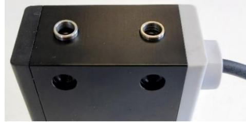
Danach wird die Adapterplatte auf die Zentrierhülsen gedrückt. Beachte: durch das Eloxal auf der Adapterplatte kann diese händisch nicht vollständig bis an das Greifergehäuse herangedrückt werden. Sobald die Adapterplatte händisch festgedrückt wurde, werden die Unterlegscheiben (DIN 9021 4,3x12x1,00) mit den entsprechenden Schrauben (DIN 7984, M4x12) angesetzt und festgezogen.
