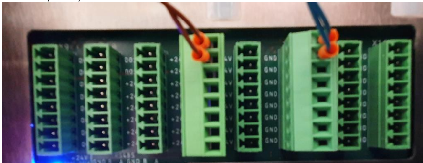
Für die Versorgungsspannung können gleich wie bei der Verwendung von nur einem Sicherheitsscanner die PowerOut 24V-Anschlüsse auf X12 und X13 verwendet werden. Für die Masse GND können die Klemmen auf X14, X15, und X16 verwendet werden.
