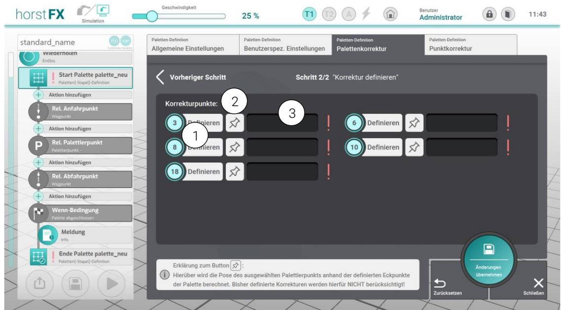
Abb. 6-45: Aktionsfenster – Paletten-Definition – Palettenkorrektur (Schritt 2)
