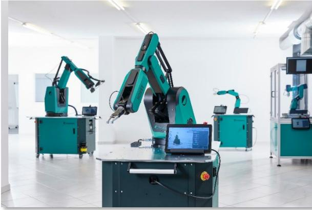
Bildunterschrift: Zum Produktportfolio von fruitcore robotics gehören drei Modelle des Digital Robot HORST mit 600 - 1.400 mm Reichweite und einer Traglast bis 12 kg.
