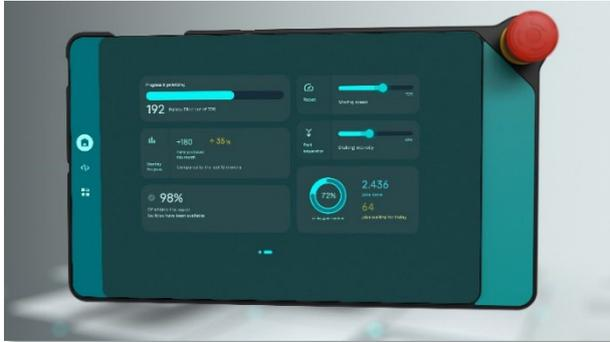
Bildunterschrift: Von einem Single Point of Control aus wird die gesamte Anwendung gesteuert und überwacht. Mit dem individualisierbaren Dashboard behält der Anwender die Produktivität der Anlage stets im Blick und hat zudem die Möglichkeit häufig anzupassende Parameter schnell und direkt zugänglich zu machen.
